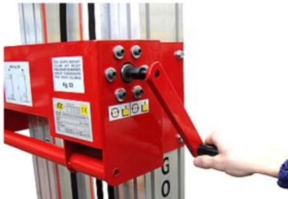
Elévation standard par manivelle (incluse)
