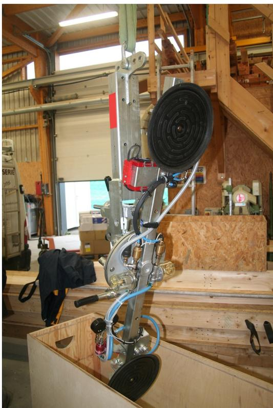
Option disponible en standard : Basculement manuel assisté. **Il vous assure de façon manuelle un basculement sécuritaire du palonnier en charge ou non avec une précision au degré près!** Système amovible en 15 secondes.
