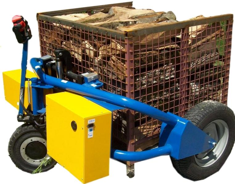
Le transpalette électrique tout terrain permet une **manutention rapide et aisée des palettes sur les terrains irréguliers type chantier.**
