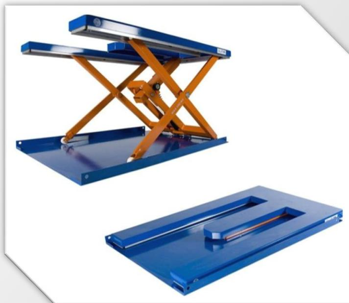
Ces tables élévatrices sont spécialement conçues pour pouvoir amener une palette à la rigidité faible directement à l'aide d'un transpalette, gerbeur ou chariot élévateur. Leur hauteur basse n'est que de 85mm. Aucun travaux n'est nécessaire à leur installation.
