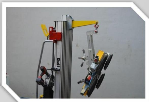
Nous pouvons vous livrer un ensemble complet équipé d'un de nos modèles de palonniers à ventouses autonomes. Le modèle le plus approprié est le VB4 RCMBM avec son faible poids de 78 Kg et sa capacité de 400 Kg.
