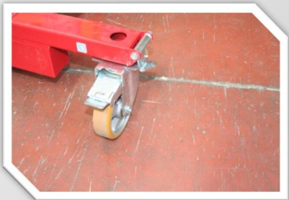
Les grandes roues pivotantes des stabilisateurs (qui se rangent dans un support spécifique intégré à la structure) dispose d'un blocage de position pour pouvoir déplacer le BULL de façon aisée dans la direction voulue.
