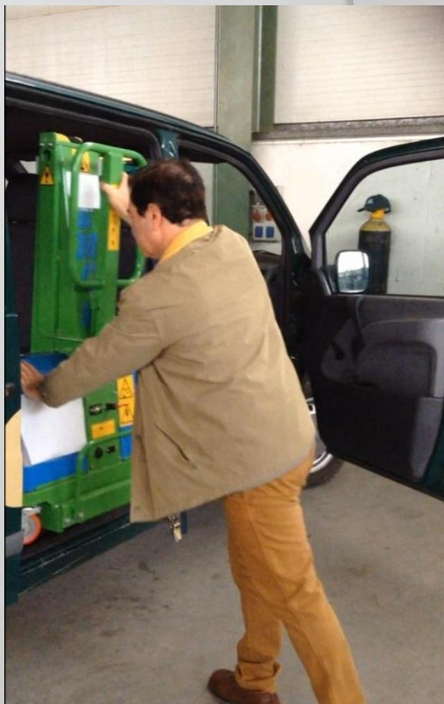
3/ Remontez la structure du gerbeur et repoussez les longerons sous les fourches puis poussez le gerbeur. Le gerbeur est chargé avec sa palette.
