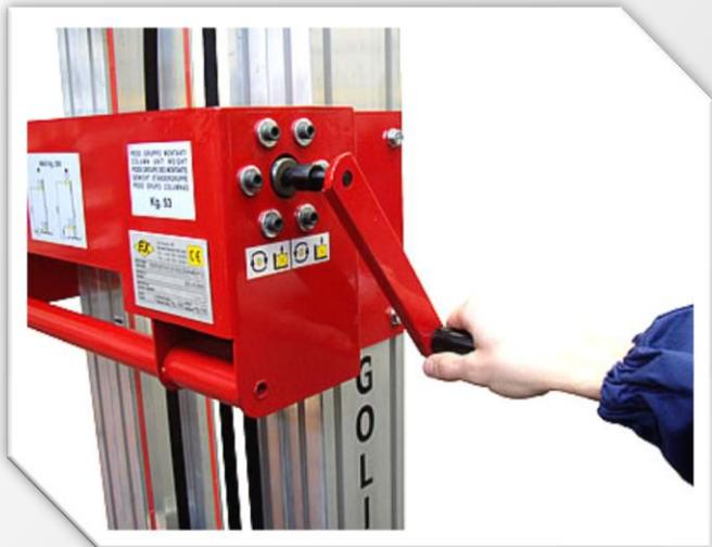
Elévation standard par manivelle (incluse)
