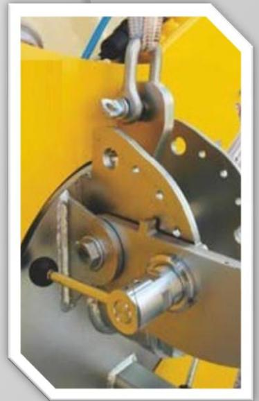
Capacité 200 Kg. Rotation et basculement manuel.
