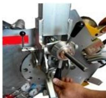
Il vous permet d'incliner le vitrage au degré près et maintenu. Pour verre maxi 300 Kg. Solution amovible
