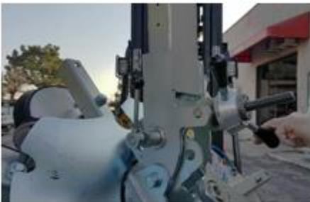
Il peut arriver de devoir incliner des vitrages en ajustant précisément l’angle de basculement
