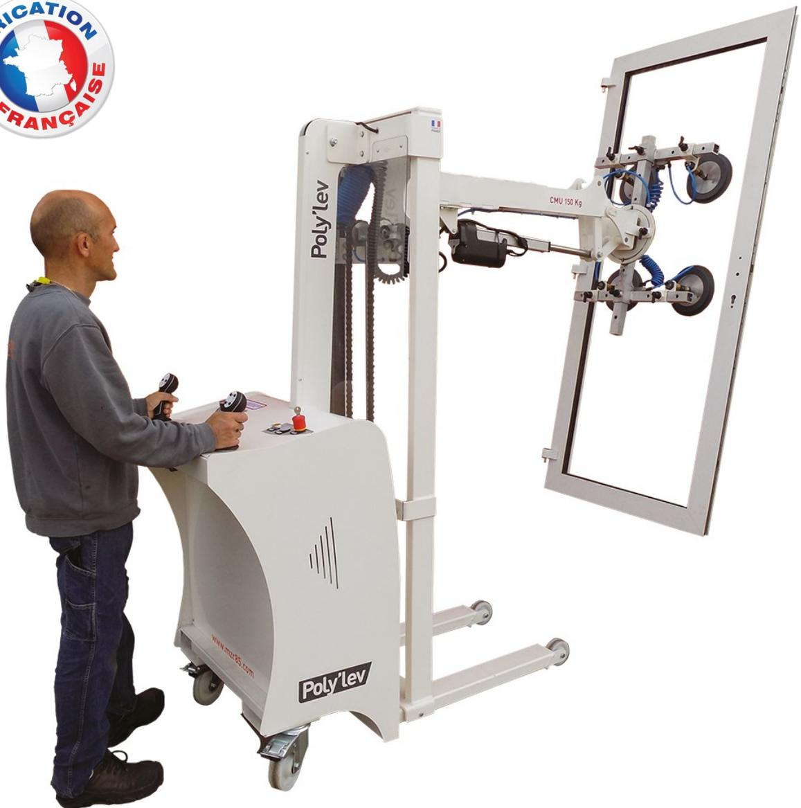
D'une **capacité de 150 Kg** et d'une **hauteur de levée à 1843 mm** au centre des ventouses, il rendra possible la manipulation de vos verres et/ou vos menuiseries finies (**soulever, basculer, retourner, déplacer**).
