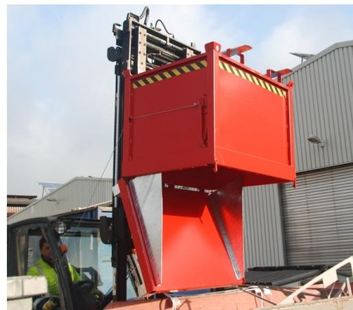
Les bennes à fonds ouvrant FB, sont **adaptées à l'évacuation des déchets longs à faible densité tels que le carton ou encore les poutres de bois ou des bandes de plâtre.**
