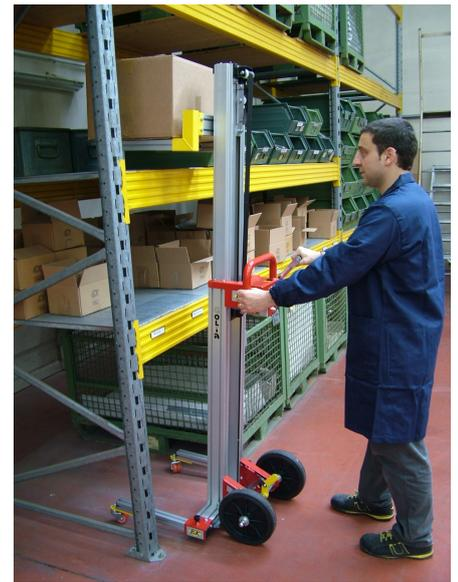
L'élévation du mât aluminium se fait à l'aide d'une manivelle (incluse) .
